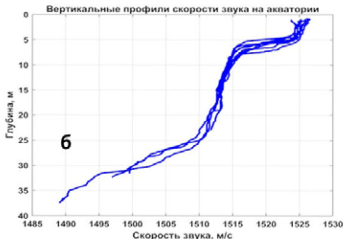
Рис. 4. Эксперимент: а – географическая схема; б – вертикальные профили скорости звука (ВПСЗ)
