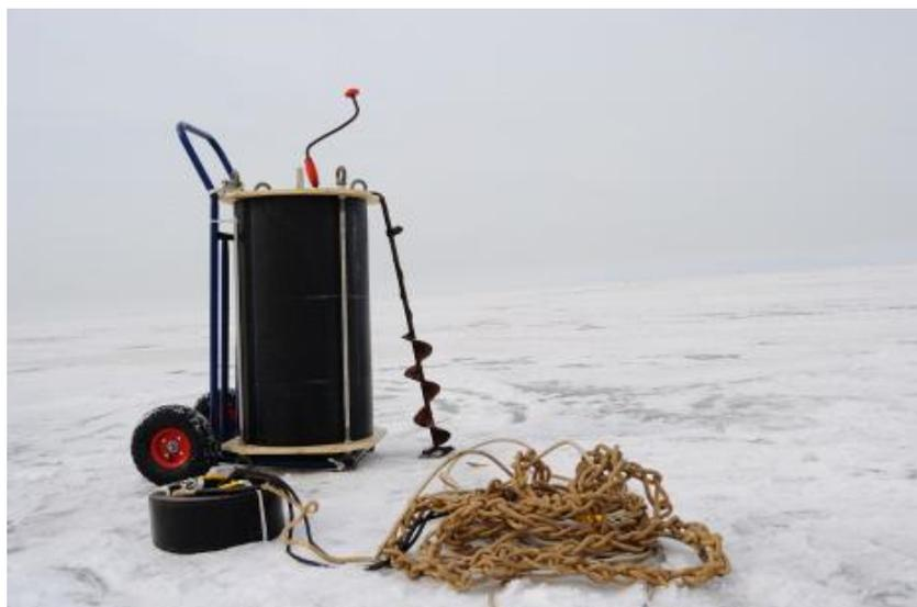
Рисунок 3.15. — Автономный блок генерации сигналов и пьезокерамический излучатель
