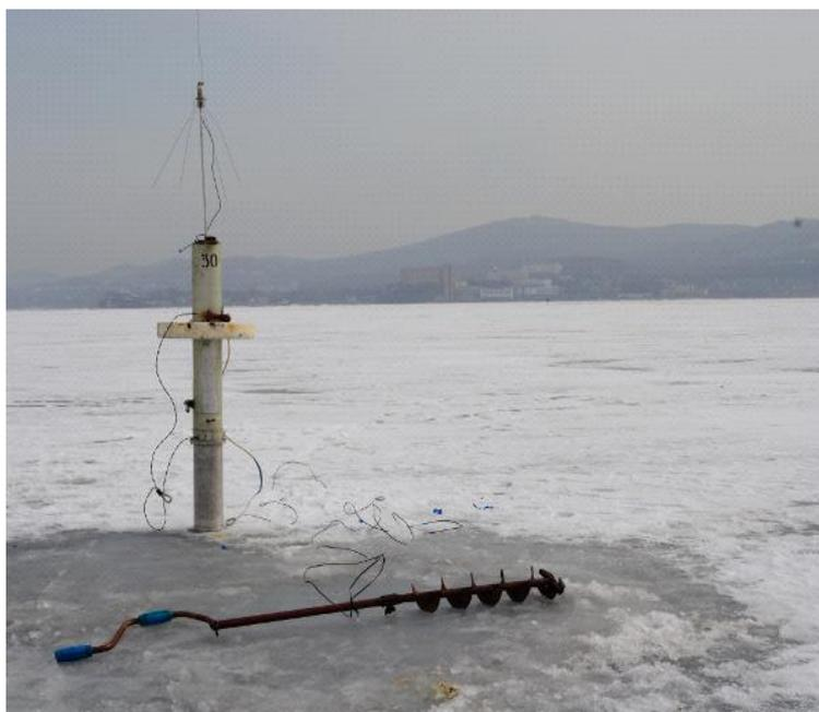
Рисунок 3.16 — Приемная система на базе РГБ.
