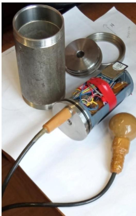
Рисунок 2.7. – Разработанный автономный цифровой гидроакустический регистратор в разборе
