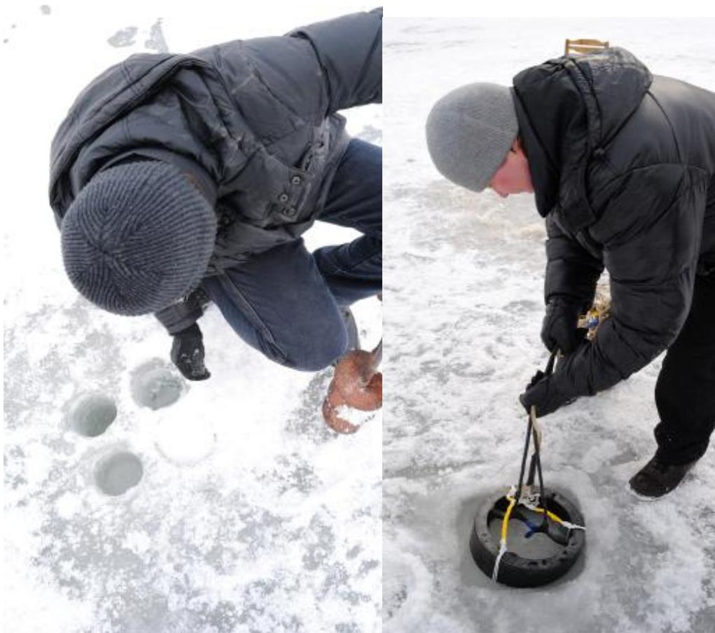
Рисунок 3.14. — Постановка пьезокерамического излучателя
