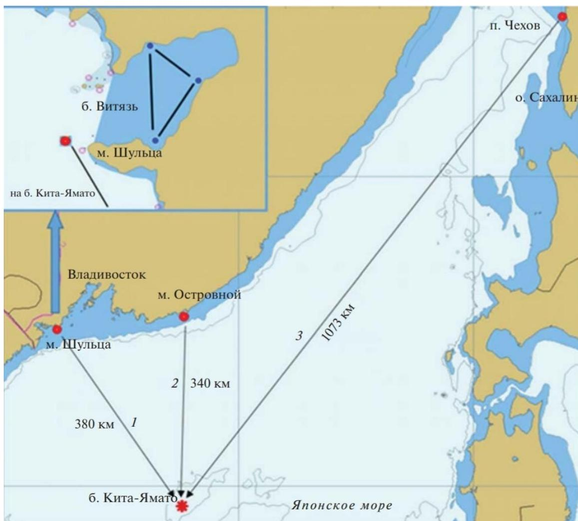
Рисунок 3.6. – Измерительная система для исследования и контроля температурных режимов в Японском море
