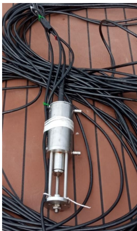
Рисунок 2.1. – Внешний вид измерителя скорости звука, разработанного в ТОИ ДВО РАН
