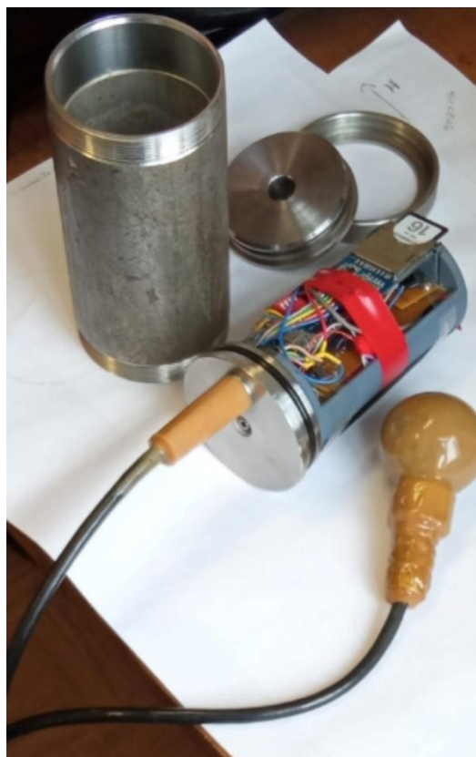
Рисунок 2.4. – Разработанный автономный цифровой гидроакустический регистратор в разборе
