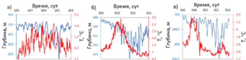
Рис. 3. Глубина (м, синие линии, левая ось ординат) и температура (°C, красные линии, правая ось ординат) на уровне L1 в периоды 2–9.11.2014 (а), 20.2–6.3.2015 (б), 2–10.4.2015 (в)
