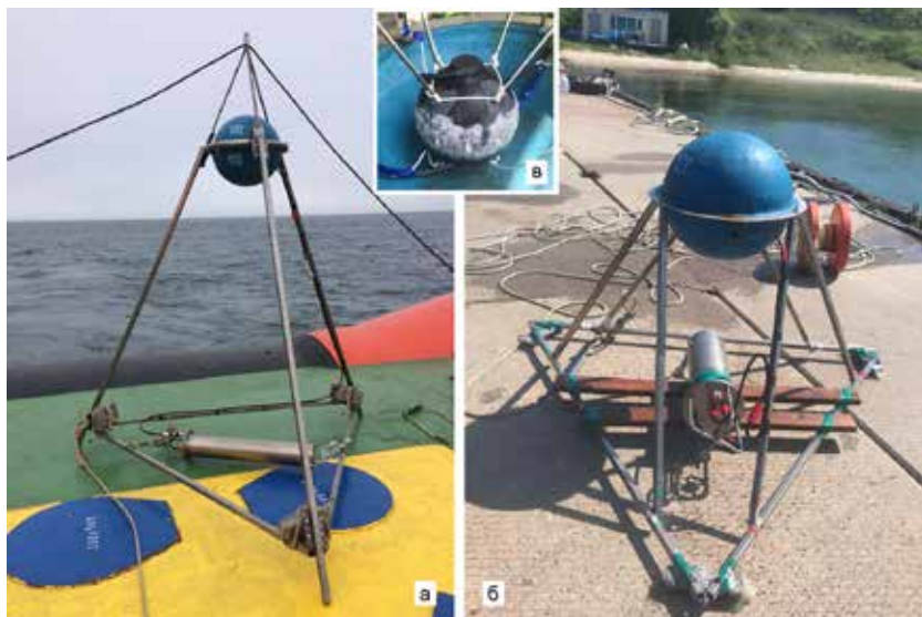
Рис. 1. Станция «Краб» при постановках с судна (а) и катера (б). Измерительный модуль станции внутри обтекателя – (в)
