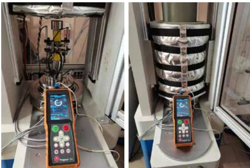
Рис. 1. Интеграция прибора Prognoz-L в лабораторный комплекс АСИС СПЕЦ ГЕОТЕК
