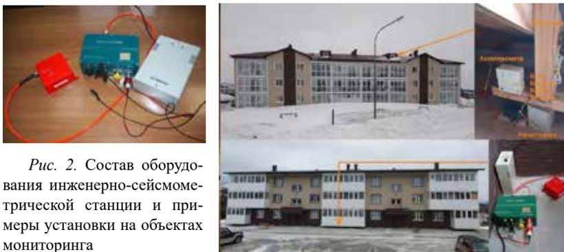
Рис. 2. Состав оборудования инженерно-сейсмометрической станции и примеры установки на объектах мониторинга
