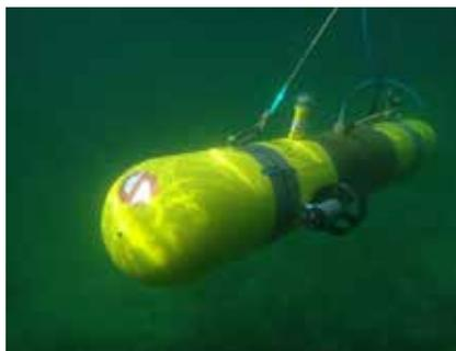
ёмную систему, размещенная на автономном необитаемом подводном аппарате типа беспилотного подводного планера (глайдера), который обладает минимальным уровнем собственных шумов и достаточной мобильностью при выборе оптимальных горизонтов позиционирования.
