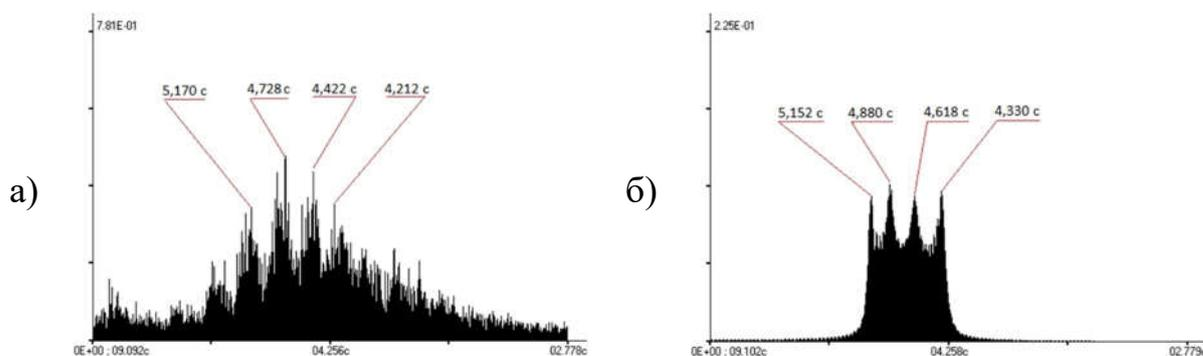
Рисунок 4.11. – а) спектр волнения, построенный по экспериментальным данным; б) спектр волнения, построенный по выражению (4.6)
