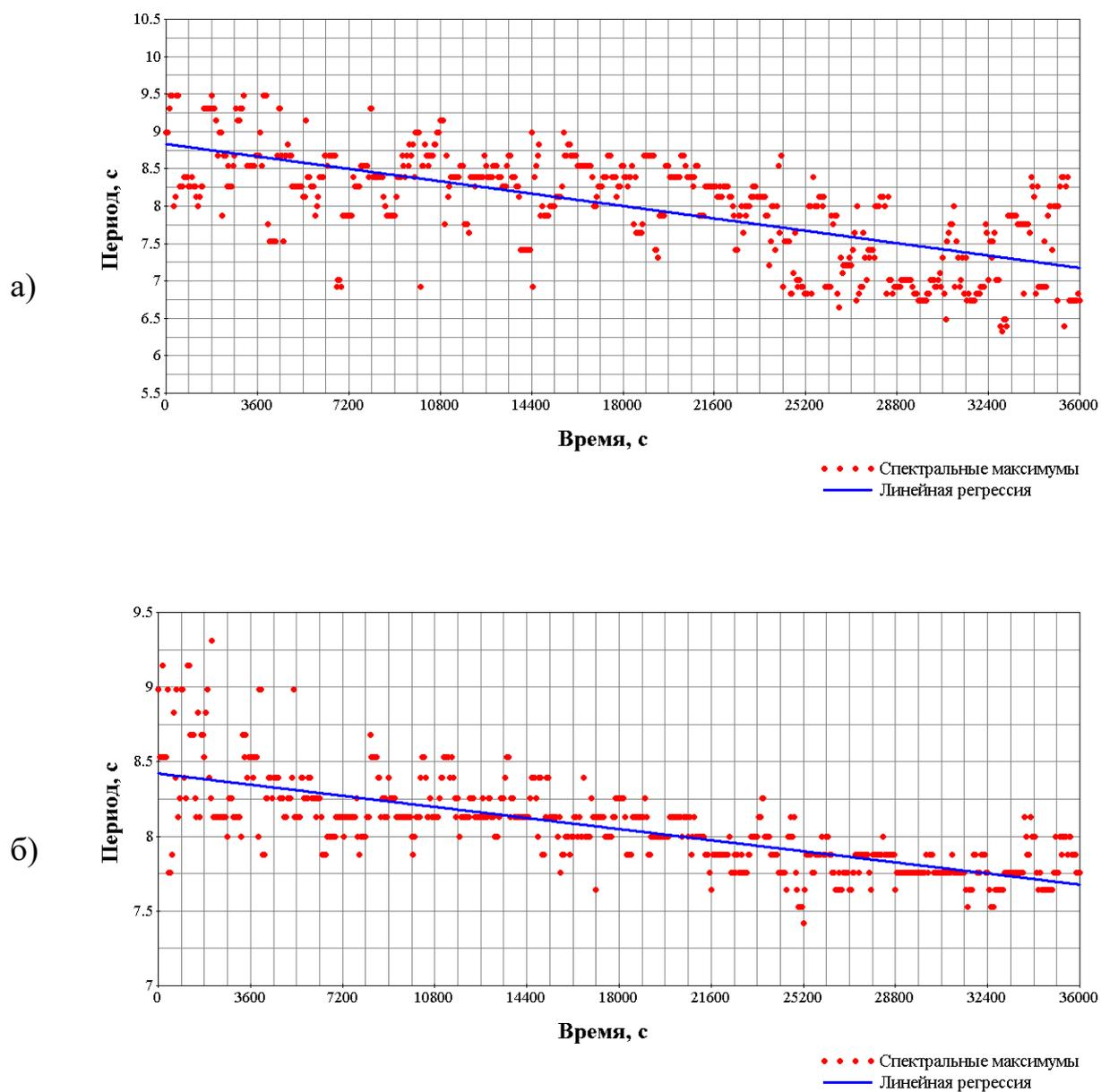
Рисунок 3.4 – Спектральные максимумы и графики линейной регрессии на выбранных 10-ти часовых участках. а) участок записи, сделанный 03.07.2013 г., б) участок записи, сделанный 12.08.2010 г.
