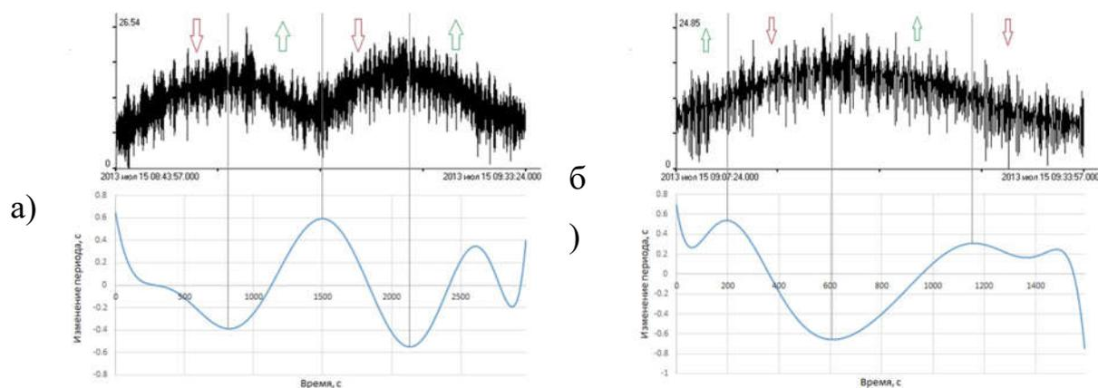
Рисунок 4.6 - а) участок записи с двумя сейшевыми колебаниями 18 мин и изменение периода ветрового волнения («двух тоновая» модуляция); б) участок записи с одним сейшевым колебанием 20 мин и изменение периода ветрового волнения («четырёх тоновая» модуляция)
