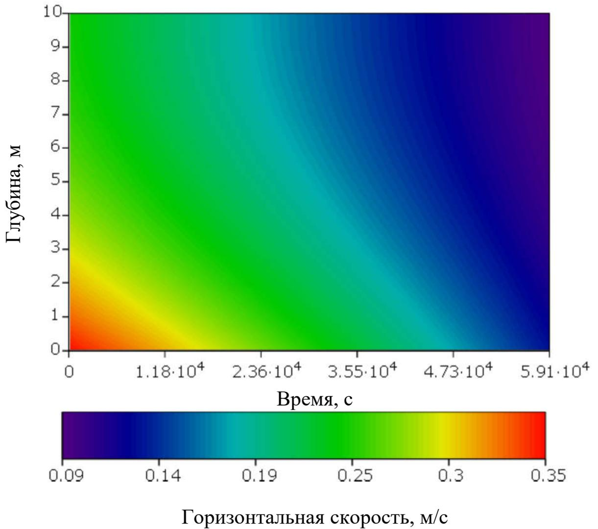
Рисунок 5.6 - Пространственно-временное распределение мгновенных значений горизонтальной скорости частиц на глубине  $z$  в водоеме конечной глубины  $h$  в приближении мелкой воды.
