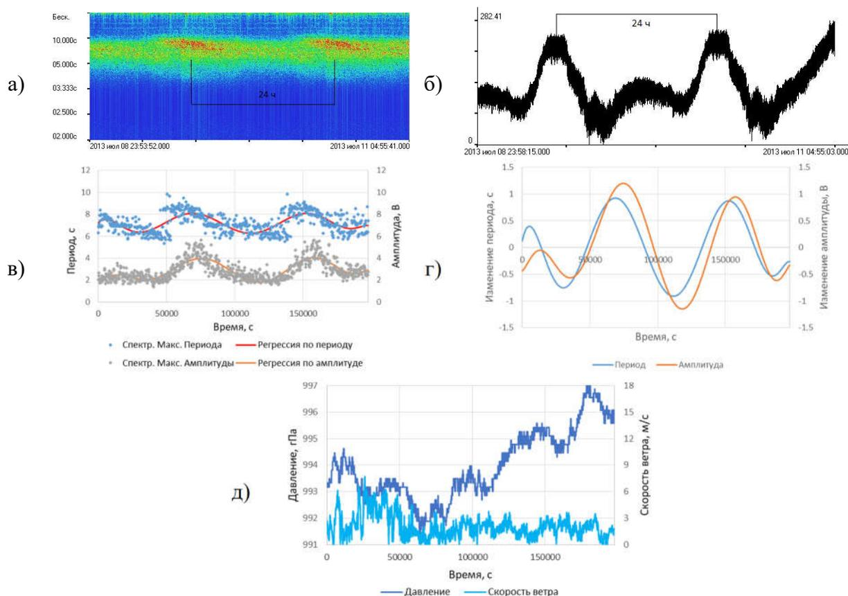
Рисунок 4.3 – а) спектрограмма сигнала; б) сигнал; в) спектральные максимумы периода и амплитуды волнения и регрессии, построенные по
