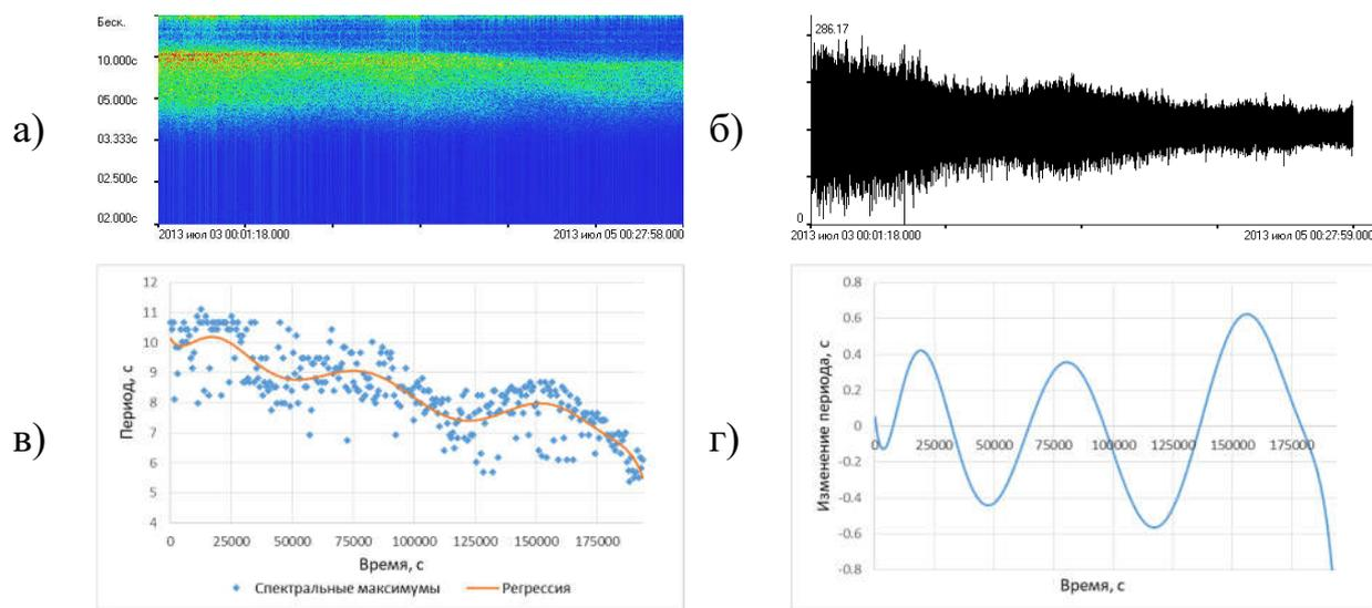
Рисунок 4.1 – а) спектрограмма сигнала, б) сигнал, в) спектральные максимумы и график регрессии, построенный по (4.3), г) абсолютные значения изменения периода волн зыби, выделенные по (4.4).
