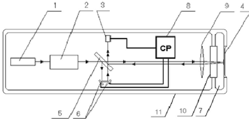
Рисунок 2.1 - Оптическая схема и устройство лазерного измерителя вариаций давления гидросферы. 1 - лазер, 2 - оптический затвор и коллиматор, 3 – фотодиод, 4 – мембрана с наклеенным зеркалом, 5 - полупрозрачная плоскопараллельная пластина, 6 - плоскопараллельные юстировочные зеркала на пьезокерамических цилиндрах, 7 – компенсационная камера, 8 – система регистрации, 9 – линза, 10 – плоскопараллельная пластина, 11 – герметичный корпус прибора.
