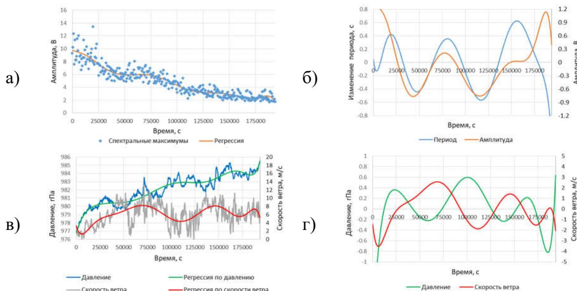
Рисунок 4.2 – а) спектральные максимумы амплитуды волнения и регрессия, построенная по ним; б) абсолютные значения вариаций периода и амплитуды волнения; в) данные по атмосферному давлению и скорости ветра и графики регрессий, построенные по ним; г) абсолютные значения вариаций атмосферного давления и скорости ветра.
