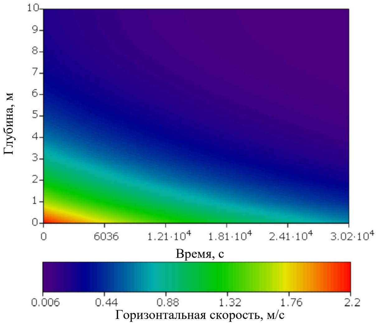
Рисунок 5.14 - Пространственно-временное распределение мгновенных значений горизонтальной скорости частиц на глубине  $z$  в водоеме конечной глубины  $h$  в приближении глубокой воды.
