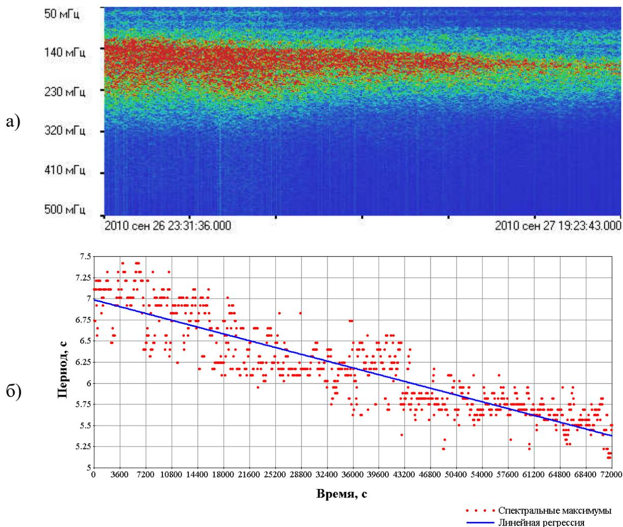
Рисунок 3.7 – а) спектрограмма записи лазерного измерителя вариации давления гидросферы, сделанная 26.09.2010 г, б) график регрессии построенный по спектральным максимумам, выделенным из спектрограммы сигнала.
