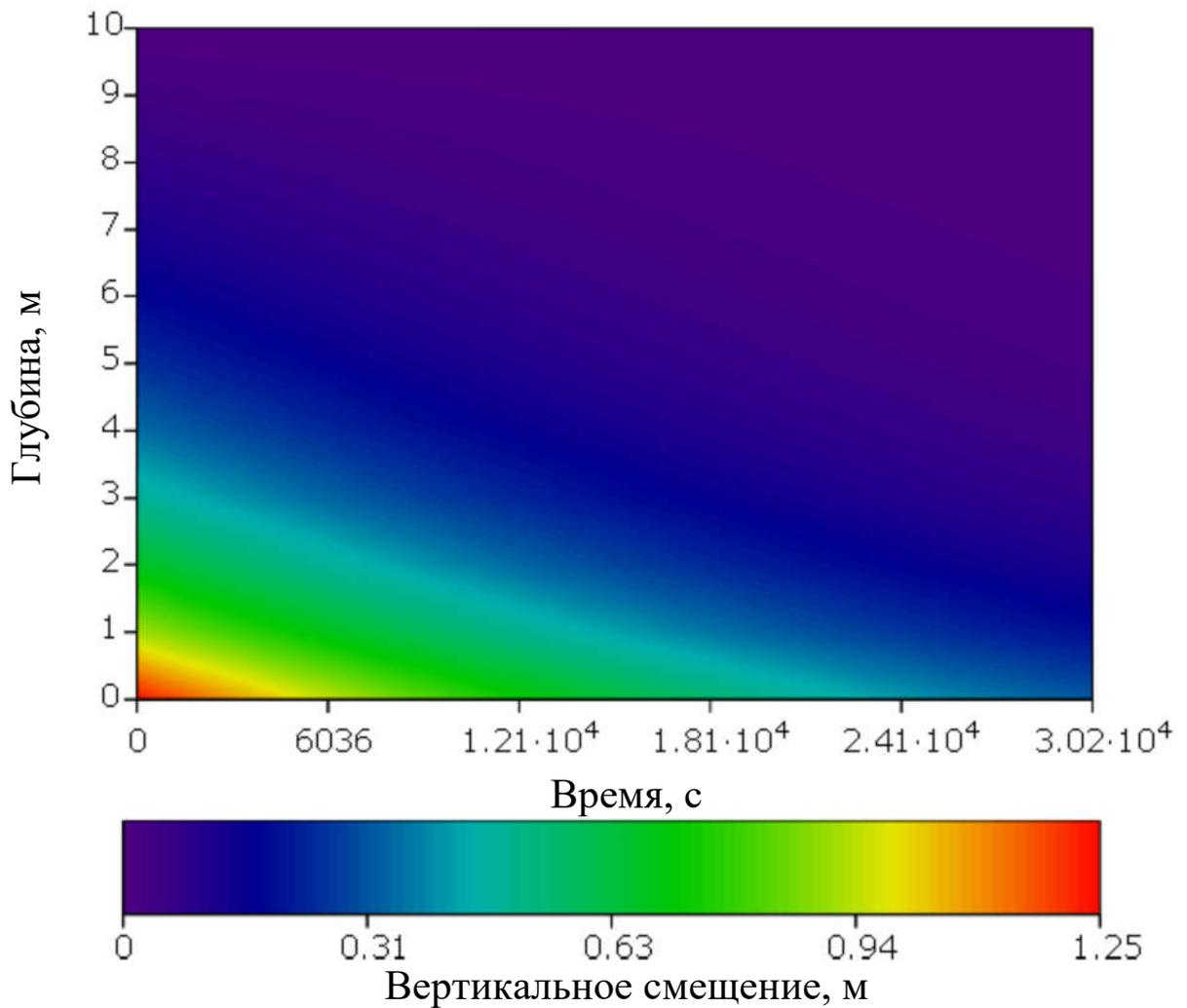
Рисунок 5.17 - Пространственно-временное распределение вертикальных смещений частиц на глубине  $z$  в водоеме конечной глубины  $h$  в приближении глубокой воды.
