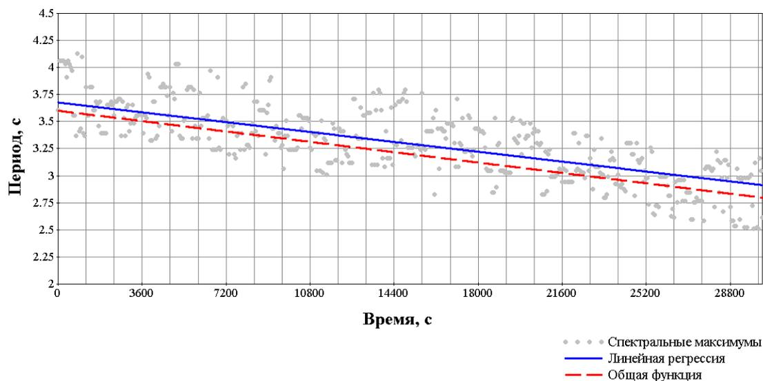
Рисунок 5.10 - График регрессии построенный по спектральным максимумам, выделенным из спектрограммы сигнала, записанного 07.09.2010 г. и общей функции изменения периода, построенного по выражению (5.14).
