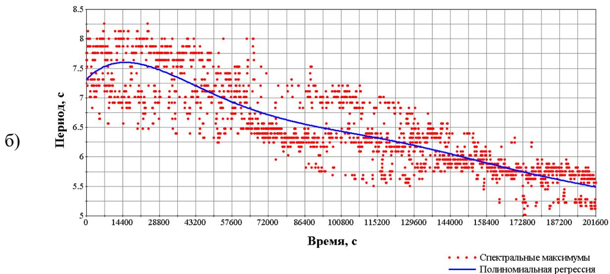
Рисунок 3.3 – а) спектрограмма записи лазерного измерителя вариации давления гидросферы, сделанная 17.08.2010 г, б) график регрессии построенный по спектральным максимумам, выделенным из спектрограммы сигнала.
