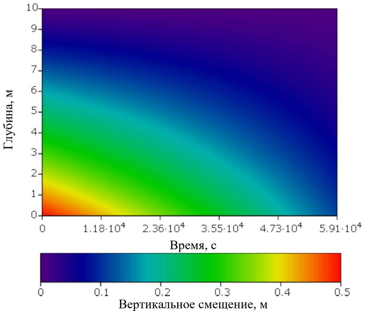
Рисунок 5.9. - Пространственно-временное распределение вертикальных смещений частиц на глубине  $z$  в водоеме конечной глубины  $h$  в приближении мелкой воды.
