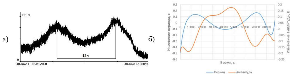
Рисунок 4.4 – а) сигнал; б) изменение периода и амплитуды волнения, связанные с модуляцией на приливных колебаниях
