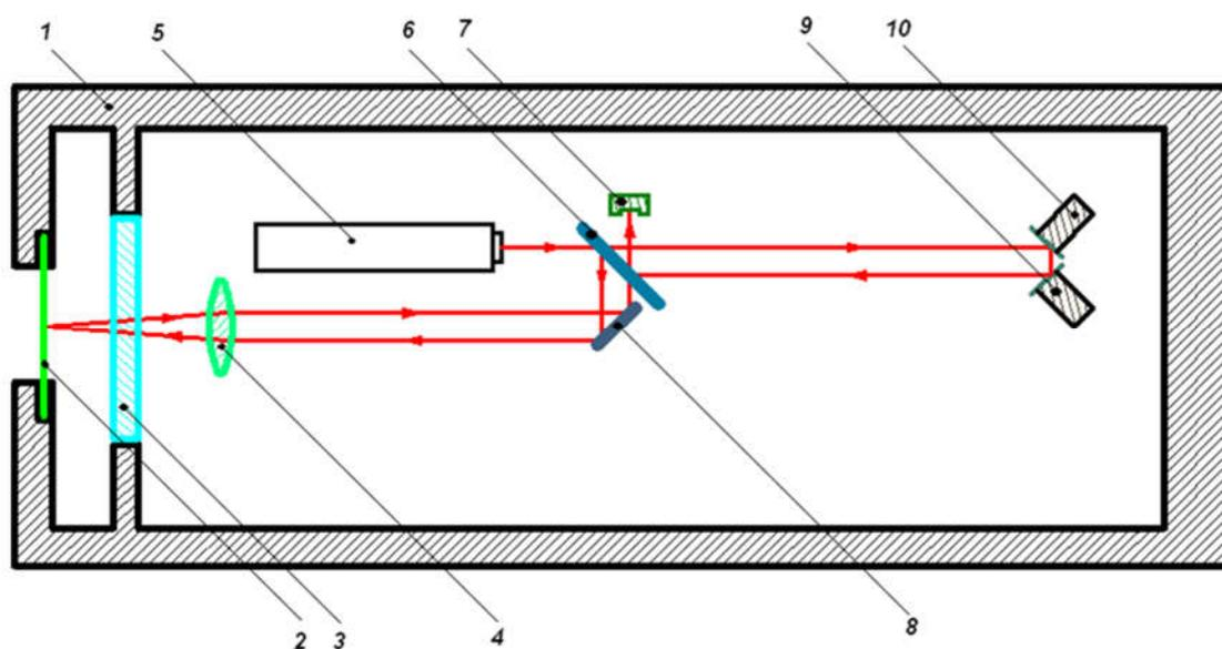
Рисунок 2.2 - Оптическая схема и устройство лазерного гидрофона. 1 - корпус, 2 - мембрана с зеркальным напылением, 3 - оптическое окно, 4- линза, 5- полупроводниковый лазер, 6 - плоскопараллельная делительная пластина, 7 - фотоприемник, 8 - дополнительное зеркало, 9 -пьезокерамика раскачки, 10 - пьезокерамика компенсации
