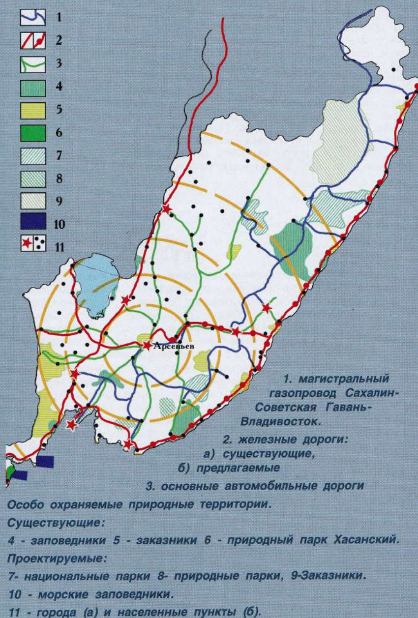
Рис. 2. Схема существующих и предлагаемых коммуникаций Приморской территориально-хозяйственной системы при рассмотрении в качестве системообразующего и управляющего регионального центра г. Арсеньева (с учетом данных П.Я. Бакланова и др. 1996).
