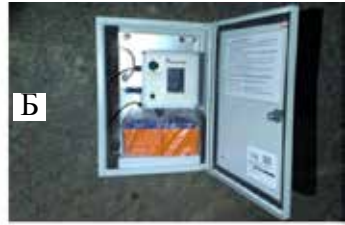
Рис. 2. Датчик деформаций ДД-3.4 (А), оснащенный модулем беспроводной передачи данных и блок управления автоматизированным контрольным комплексом АКК (Б)
