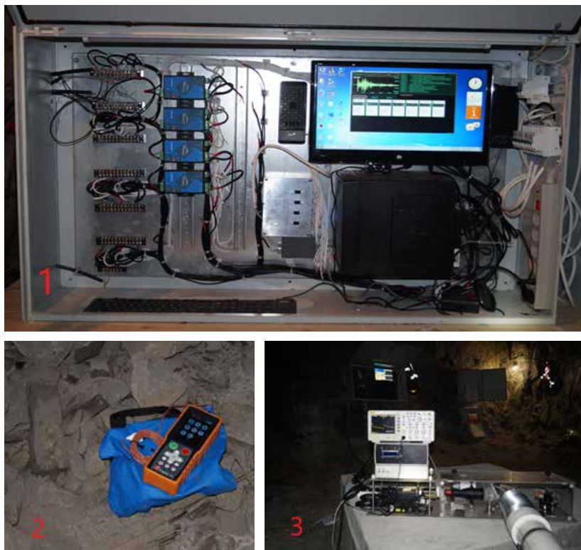
Рис. 1. Специальные технические средства для оценки удароопасности входящие в состав геодинамического полигона: 1) Автоматизированная сейсмоакустическая система контроля горного давления «Prognoz-ADS»; 2) Локальный прибор «Prognoz L2»; 3) Лазерный деформометр.
