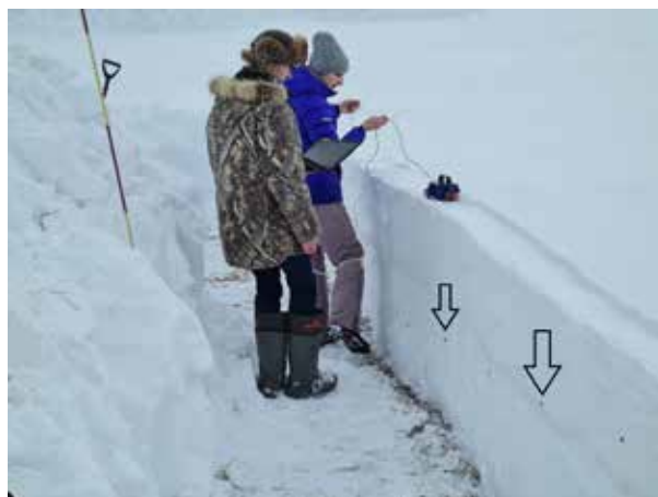
Рис. 2. Применение метода георадиолокации для индикации слоев снежной толщи
