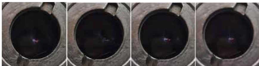
Рис. 6. Фотографии СЛ водного раствора 5М CaCl 2 . Экспозиция 1/7 сек. Фокус а) окно б) ~10 мм от окна в) ~20 мм от окна г) ~50 мм от окна вглубь. Использована заслонка, которая видна как мутный желтоватый овал в глубине. Видны 3-4 соединяющихся голубых стримера и яркий красный хвост, направленный к окну
