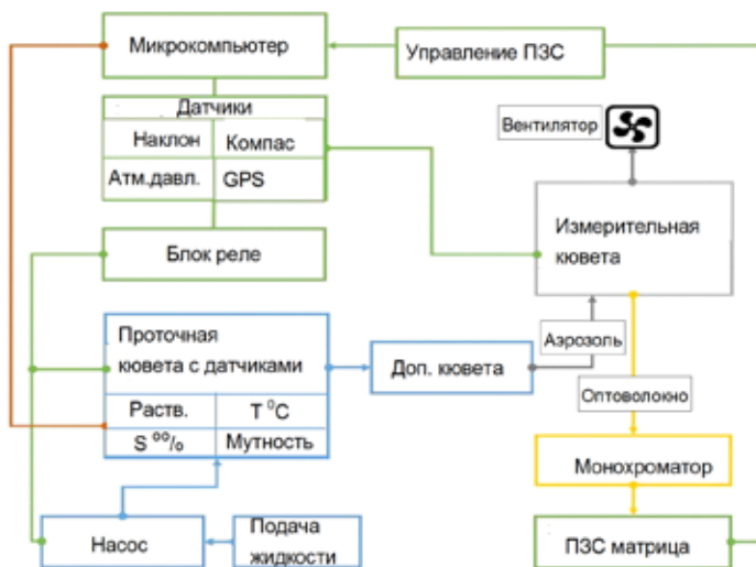
Рис. 1. Блок-схема автоматизированного комплекса для исследования гидрофизических и спектральных характеристик морской воды
