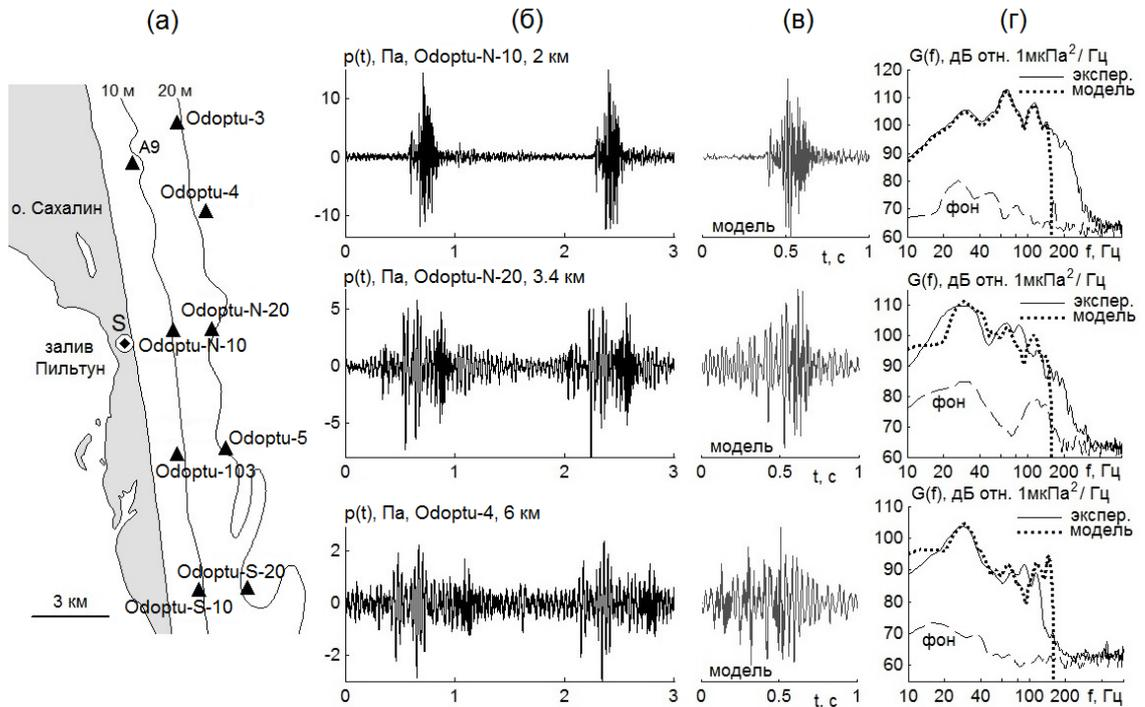
Рис. 5. Карта района исследований с указанием точек, в которых были измерены импульсные сигналы от работ по забивке свай в районе Одопту в точке S (а). Вариации акустического давления  $p(t)$ , измеренные у дна в указанных на карте точках Odoptu-N-10, Odoptu-N-20, Odoptu-4 акустического мониторинга во время забивки сваи (б), соответствующие им модельные импульсные сигналы (в) и их спектры (г).
