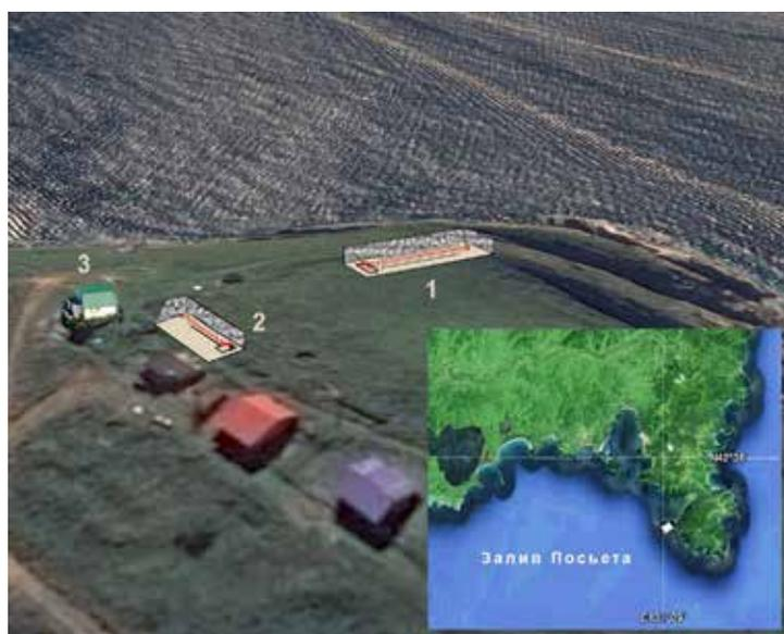
Рис. 13.1. Расположение лазерных деформографов с длинами измерительных плеч 52,5 м (1) и 17,5 м (2). 3 – лабораторное здание
