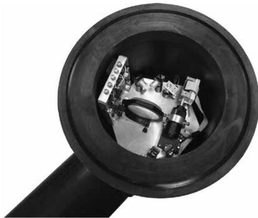
Рис. 10.35. Оптическая скамья и основные оптические элементы интерферометра
