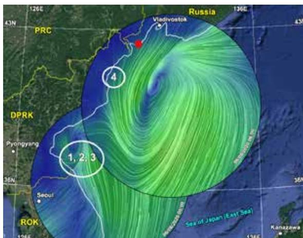
Рис. 13.20. Области генерации микросейсм «голоса моря». 1, 2, 3, 4 – последовательные (по времени) области генерации микросейсм «голоса моря». Красной звёздочкой указано место расположения двухкоординатного лазерного деформографа
