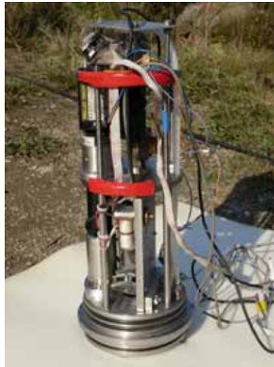
Рис. 15.1. Внутренний вид сверхчувствительного сенсора вариаций гидросферного давления
