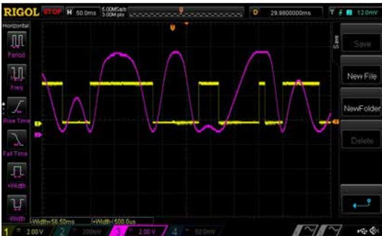
Рис. 10.27. Осциллограмма выходного сигнала фазового детектора (желтый) и выхода фильтра высокой частоты (фиолетовый)
