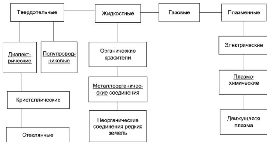
Рис. 1.1. Классификация лазеров
