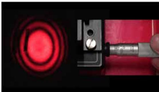
Рис. 10.3. Вид интерференционной картины в интерферометре Майкельсона и юстировочный узел, изменяющий разность хода лучей
